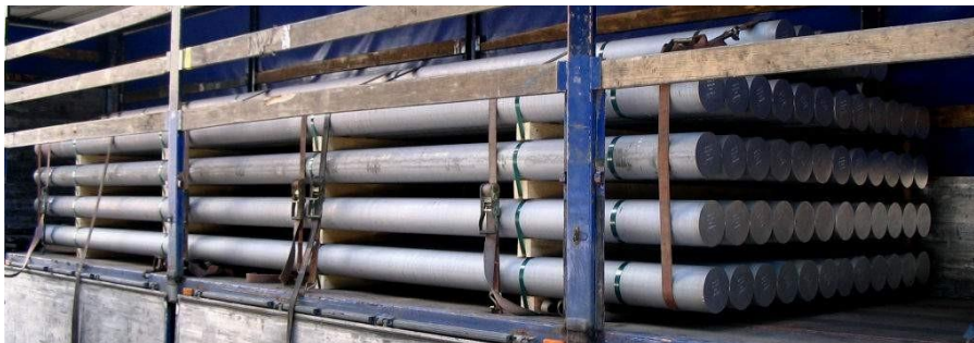
Loading of extrusion ingots Ø 178 mm - length 7 m - posledná vrstva neúplná
